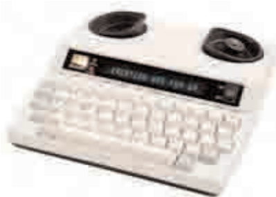
Şəkil 1.4. TDD qurğusu eşitmə qüsuru olan insanlara telefon xətti vasitəsilə ünsiyyət qurmağa imkan verir.
